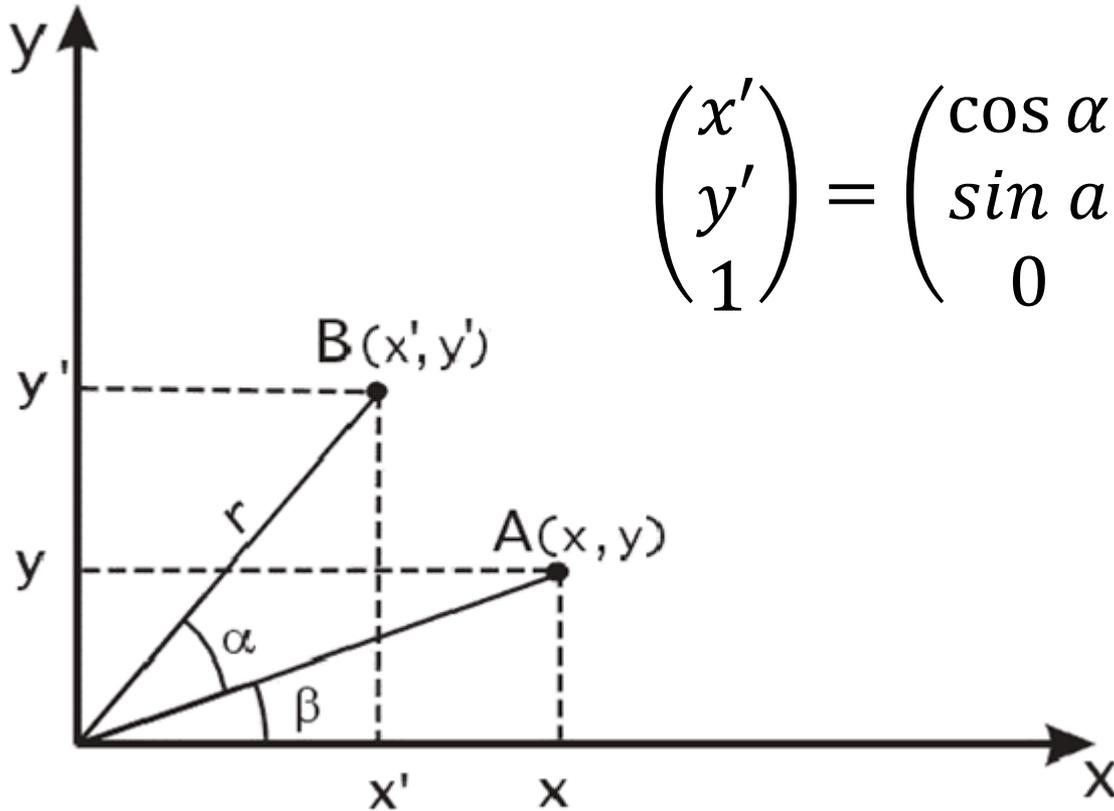
$$\begin{pmatrix} x' \\ y' \\ 1 \end{pmatrix} = \begin{pmatrix} \cos \alpha & -\sin \alpha & 0 \\ \sin \alpha & \cos \alpha & 0 \\ 0 & 0 & 1 \end{pmatrix} \begin{pmatrix} x \\ y \\ 1 \end{pmatrix}$$
