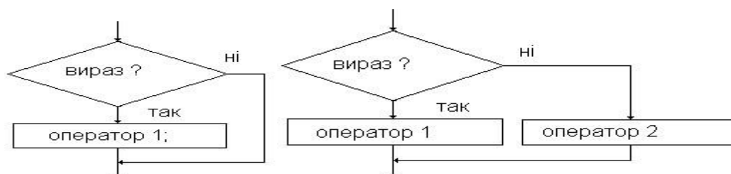
Рисунок 7 - Алгоритми роботи операторів if
